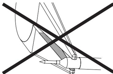
Greifen Sie nicht mit der Zange auf die Kunststoffisolierung oder das Tastkopfgehäuse.
