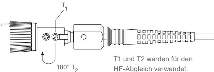
T1 und T2 werden für den HF-Abgleich verwendet.
